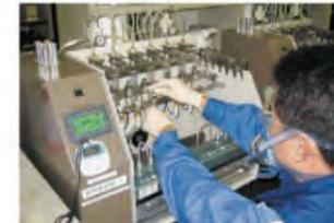
変圧器やコンデンサの絶縁油に含まれるPCBの分析診断のほか、受変電設備の絶縁油を分析し、設備の異常を診断
